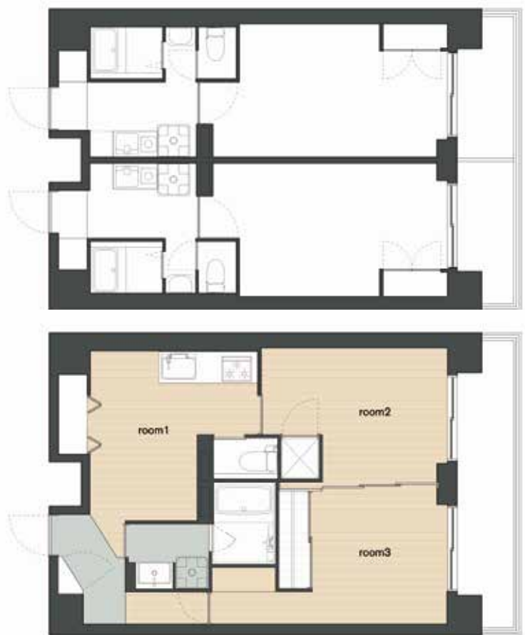
図1：上がリノベ前、下がリノベ後。全個室にせず可動式間仕切りなどを用いて回遊性を持たせた。
