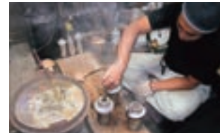
錫型にかした錫を流しこむ作業
